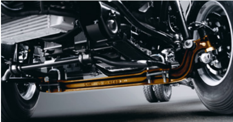
Стабилизаторы поперечной устойчивости на передней и задней оси Для лучшей управляемости и устойчивости.
