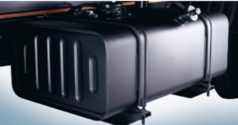
Топливный бак объёмом 100л. или 150л. Большой запас топлива для длительных поездок.
