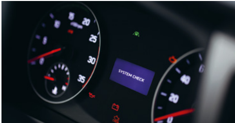
Бортовой компьютер Основные функции: средний расход топлива, запас хода, ошибки, напоминание о прохождении технического обслуживания и время.
