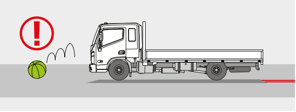
Система помощи при экстренном торможении (HAB) Распознает экстренное торможение и автоматически усиливает давление гидравлического тормоза, чтобы максимально увеличить тормозное усилие.
