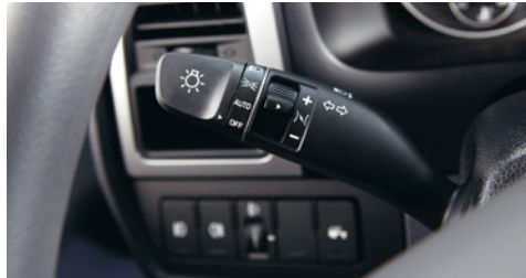
Мультифункциональный подрулевой переключатель Одним переключателем можно управлять: поворотниками, светом и оборотами двигателя на холостом ходу.
