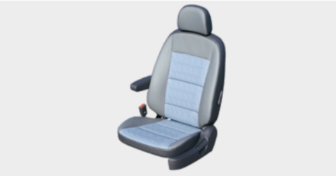
Водительское сиденье на рычажно-пружинной подвеске с подлокотником Особенно актуально для длительных поездок.
