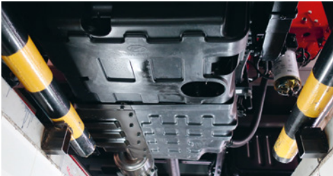
Защита картера двигателя Защитит картер двигателя от возможного повреждения.
